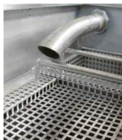
Сетчатый фильтр для грубых загрязнений в RWR 500 DB
